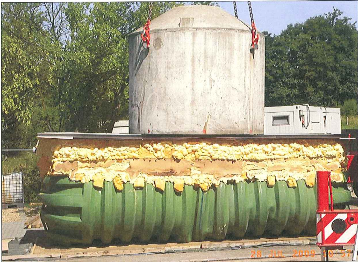
Bild 5: Behälter nach Versagensbelastung
